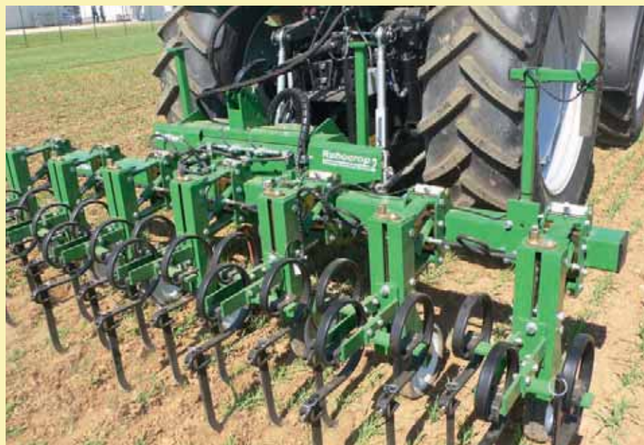
Le guidage centimétrique autorise les opérations de binage dans des céréales semées avec des inter-rangs classiques de 15 cm.
